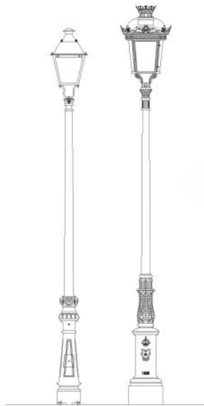
DETALLE. CANDELABRO Y LUMINARIA DE EXTERIOR TIPO FERNANDO VII ( FERNANDINA) TIPO VILLA
